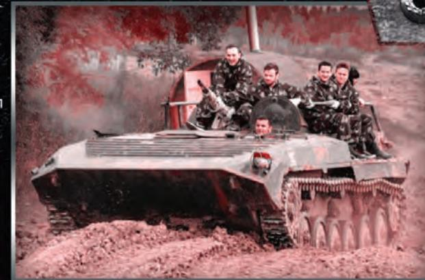
Первая в мире серийная боевая машина пехоты плавающая, предназначенная для транспортировки личного состава к месту выполнения боевой задачи
